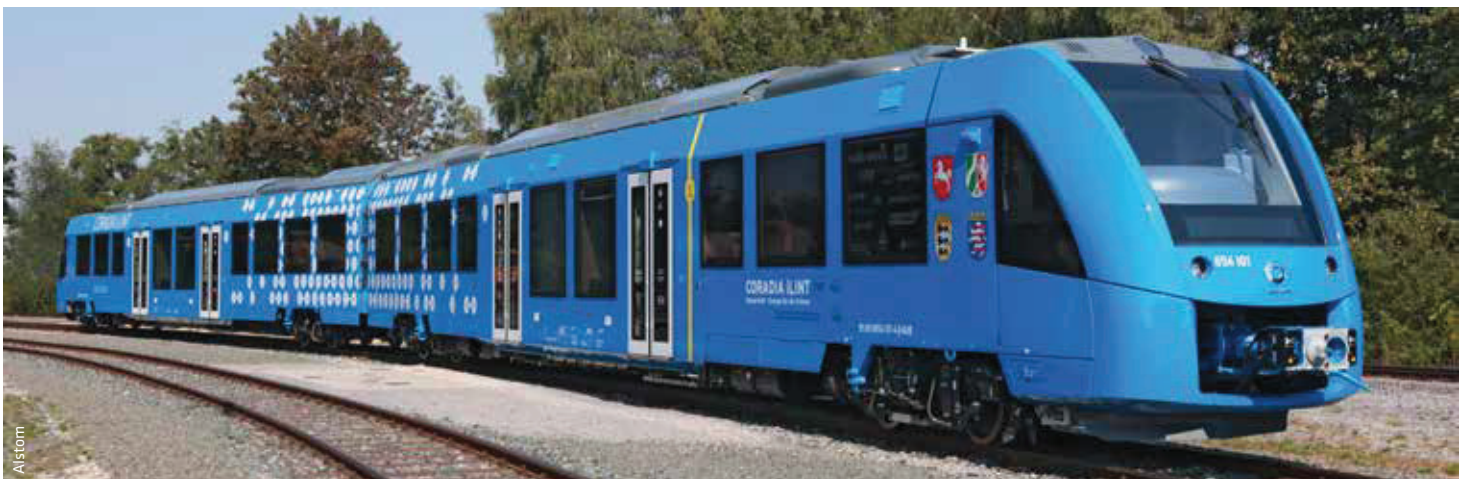
Sinnvolle Wasserstoffanwendung: Der Coradia iLint von Alstom ist der erste Zug mit Brennstoffzellen-Antrieb zum Einsatz auf Strecken mit fehlender Oberleitung.
