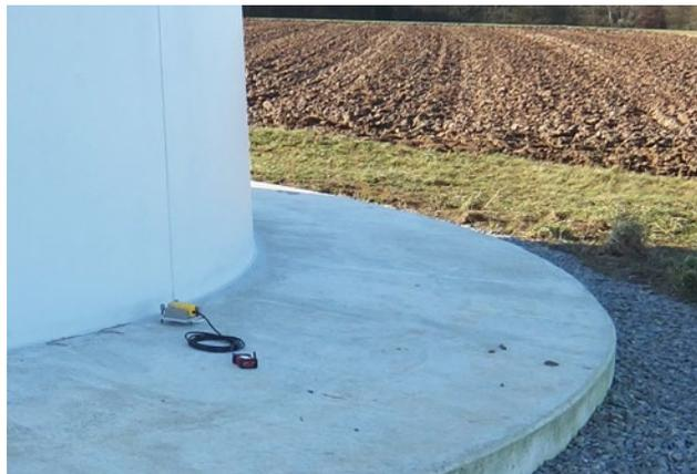
**Abbildung 4.8-1:** Erschütterungs-Messpunkt MP A am Turmfundament der WEA 5. Foto: Fa. Wölfel
