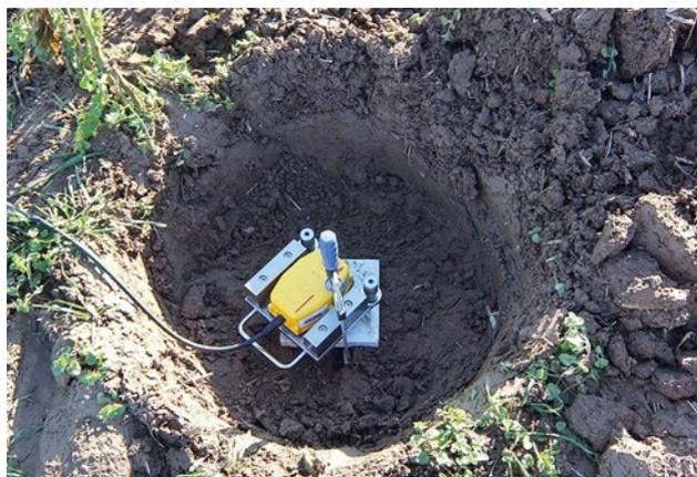
**Abbildung 4.8-2:** Erschütterungs-Messpunkt MP D auf Erdspeiß in 285 m Abstand von der WEA 5. Foto: Fa. Wölfel
