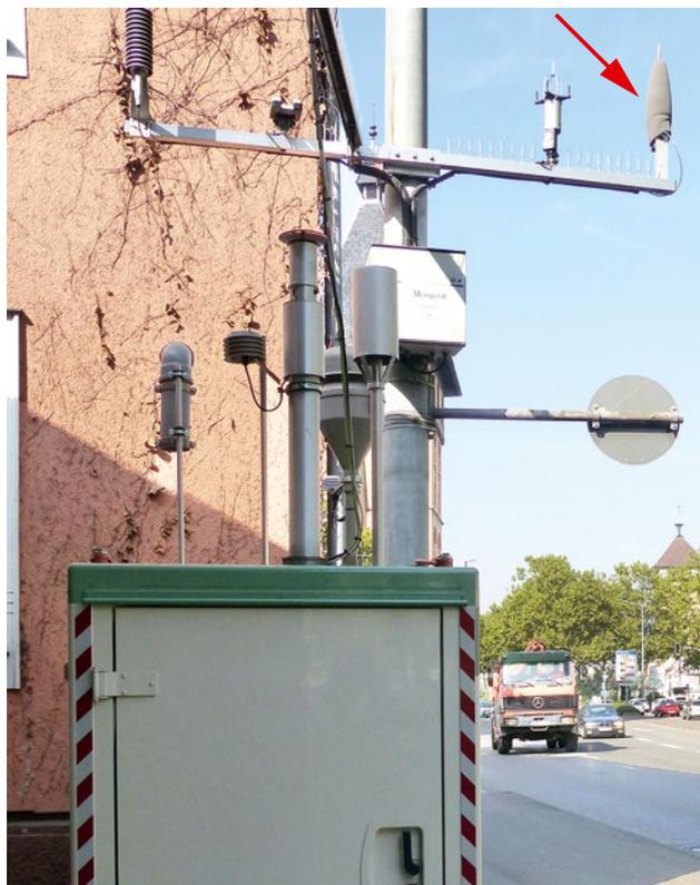
**Abbildung 5.2-2:** Messstation der LUBW zur Erfassung von Straßenverkehrslärm in Reutlingen, Lederstraße. Der Pfeil zeigt die Lage des Mikrofons. Foto: LUBW
