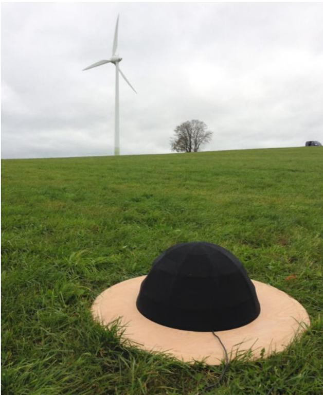
**Abbildung 4.3-1:** Messpunkt MP1 mit Mikroskop, schallharter Platte und doppeltem Windschirm. Im Hintergrund die 120 m entfernte Windenergieanlage WEA 2. Foto: Fa. Wölfel.
