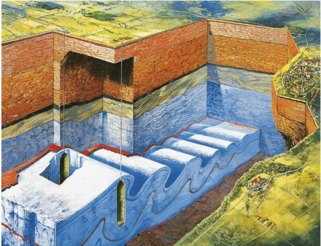
Abbildung 10: Querschnitt des Erdgas-Kavernenspeichers Reckrod (Quelle: Mainova)
