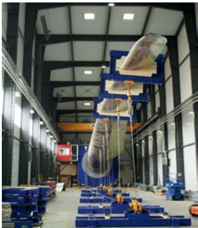
Rotorblattprüfstand des Fraunhofer IWES, © Fraunhofer IWES
